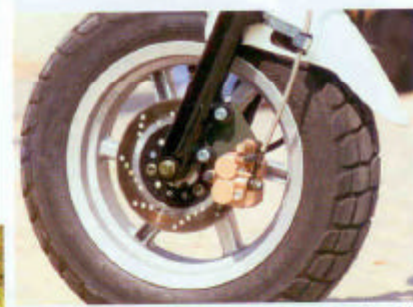
Ruedas de 12" y freno de disco con pinza de doble pistón
